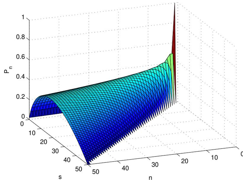
Figura 6.4: Probabilidad de éxito en función del umbral y del número de objetos.
